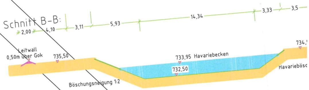
Längsschnitt Entleerung Havariebecken
